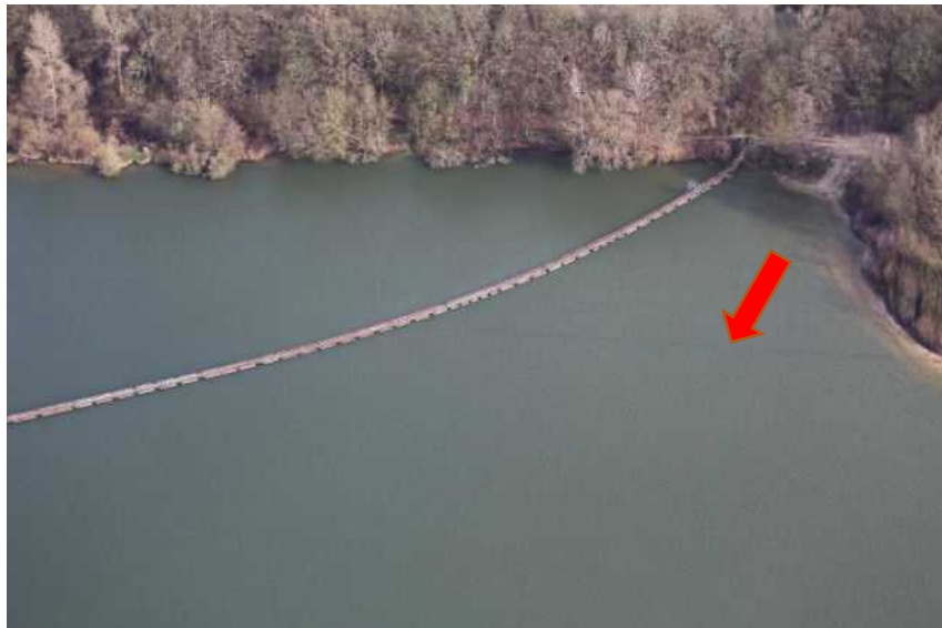
Abbildung 1: Befestigungskabel einer Schwimmleitung unterhalb der Wasseroberfläche [Bild: Fliegerstaffel NRW]
